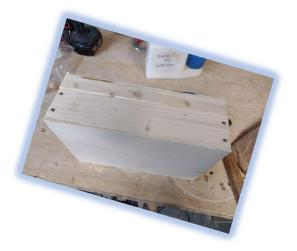
Lasst den Leim mind. 10 Minuten so trocknen. Um einen perfekten Halt zu gewährleisten, könnt ihr anschließend mit ein paar normalen Nägeln die Grundplatte zusätzlich an die Wände nageln. Die Seitenwände können zusätzlich mit den goldenen Polsternägeln an die Vorder- und Rückwand genagelt werden (s. schräges Bild oben). Die Polsternägel geben der Kiste den echten Schatzkisten-Look.
